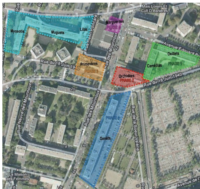
Plan de phasage prévisionnel des travaux (hors plantations selon période des travaux)
